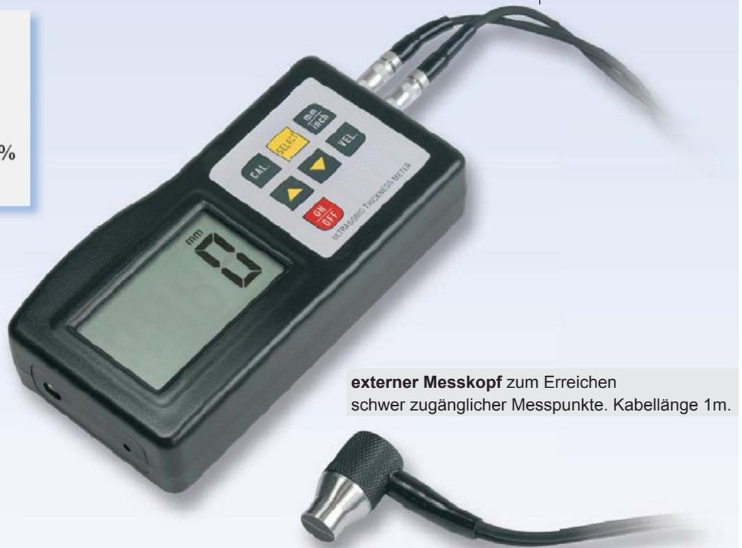
**externer Messkopf** zum Erreichen schwer zugänglicher Messpunkte. Kabellänge 1m.
