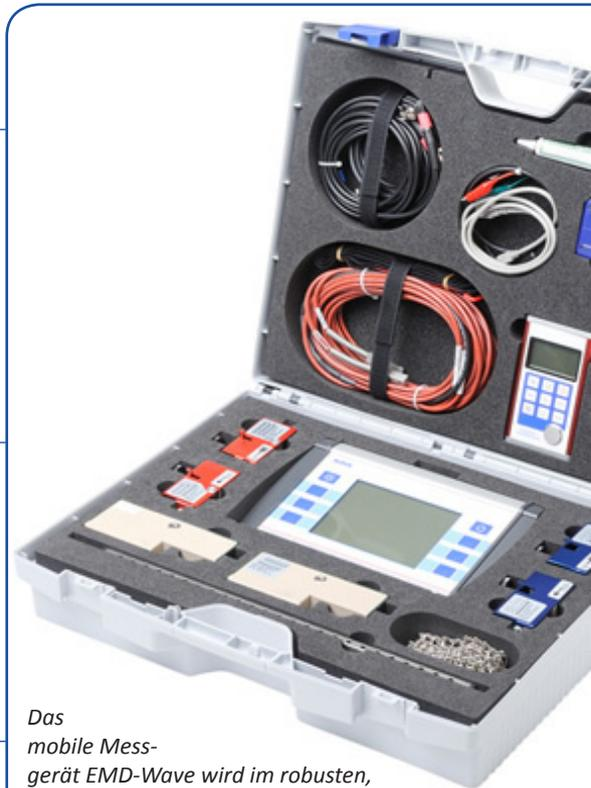
Das mobile Messgerät EMD-Wave wird im robusten, praktischen Transportkoffer als Komplettpaket mit Messumformer, Ultraschallwandlern, Montagematerial, Signalkabel und Koppelgel, sowie SD-Speicherkarte und Netzteil geliefert.
