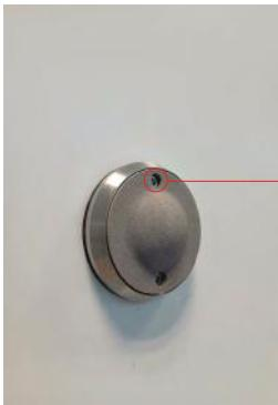
Le filtre peut être endommagé, les mesures sont affectées et l'étanchéité n'est plus garantie.
