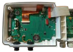
O módulo de comunicação sem fios está corretamente introduzido.
