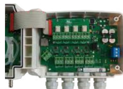
Das Relaismodul ist korrekt eingesetzt und funktionstüchtig.
