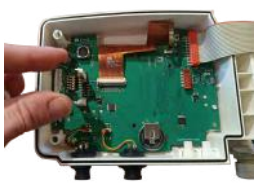
如图, 将无线通讯模块 插入到支架中
