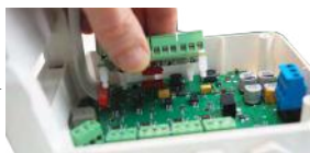
将继电器模块对准垫片孔 (见左图1) 和红色连接头 (左图2) 放置。
