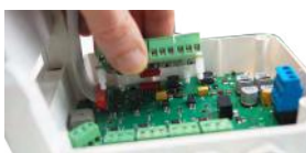
Placer le module relais en faisant correspondre les trous pour les entretoises (1 sur l'image précédente) et le connecteur rouge (2 sur l'image précédente).
