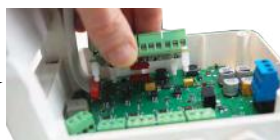
Plaats de relaismodule zodanig dat de gaten voor de afstanderingen (1 op de voorgaande afbeelding) en de rode connector (2 op de voorgaande afbeelding) tegenover elkaar staan.
