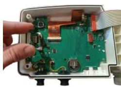
Sujete el módulo de comunicación inalámbrica con los dedos tal como se indica en la imagen y deslicelo entre los dos soportes.
