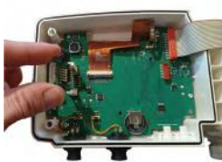
Halten Sie das drahtlose Kommunikationsmodul zwischen Ihren Fingern, wie in der Abbildung gezeigt, und schieben Sie es zwischen die beiden Halterungen.
