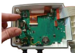
Tenir le module de communication sans fil entre vos doigts comme indiqué sur l'image et le faire glisser entre les deux supports.
