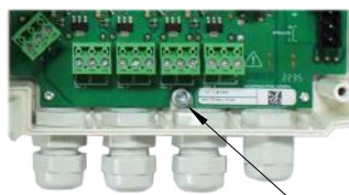
Bevestigingsschroef van het kastje
